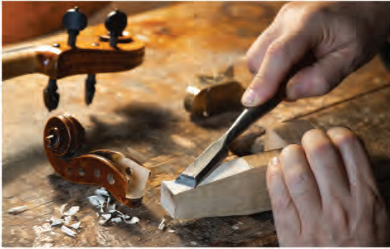
Opération d'une enture (greffe d'un nouveau manche sur une tête originale)
